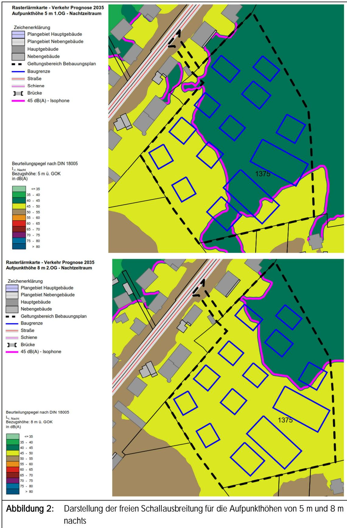
Es zeigt sich, dass es bei freier Schallausbreitung in den Aufpunkthöhen von 5 m und 8 m bis zu dem Baufeld WA 1 zu Beurteilungspegeln von über 45 dB(A) nachts und somit zu Überschreitung der Orientierungswerte der DIN 18005 kommt. Daher sind Schallschutzmaßnahmen zu prüfen.
