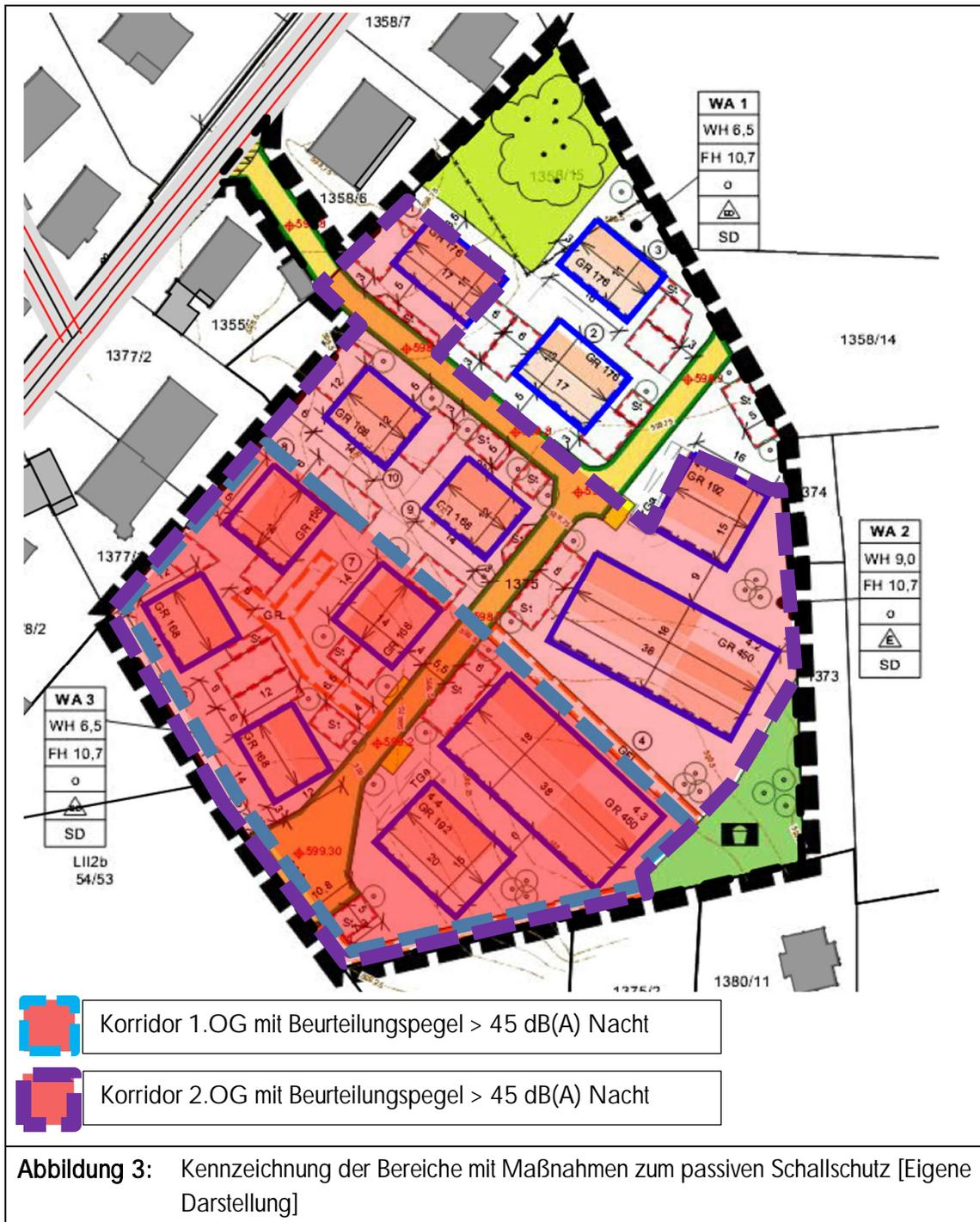
Generell müssen an den Fassadeabschnitten mit Überschreitung der Orientierungswerte der DIN 18005, bzw. der Immissionsgrenzwerte der 16. BImSchV die Außenbauteile schützenswerter Räume durch passive Schallschutzmaßnahmen geschützt werden. Diese werden durch Anforderungen an die Schalldämmung von Außenbauteilen konkretisiert. Hierfür ist die bauaufsichtlich eingeführte Norm DIN 4109 „Schallschutz im Hochbau“ [9] maßgeblich.
